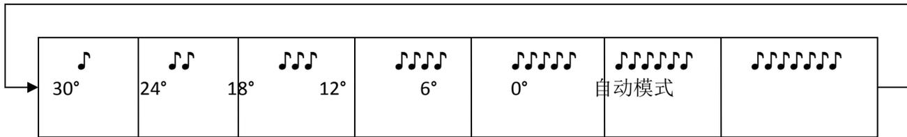
在想要的设置蜂鸣音数响过之后，将油门杆推至全油门位置。确认音：🎵 设置完成
