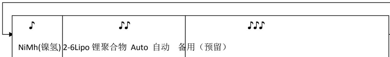
在想要的设置蜂鸣音数响过之后，将油门杆推至全油门位置。。确认音：
