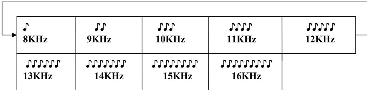
在想要的频率设置时（B 声计数）移动油门摇杆到全功率位置。确认音：🎵 设置完成。
